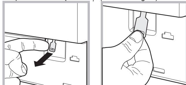
4. utilizând dispozitivul indicat în figură, trageți spre dumneavoastră până când eliberați tirantul de plastic din opriitor; trageți apoi în jos și, în același timp, deschideți ușa.
